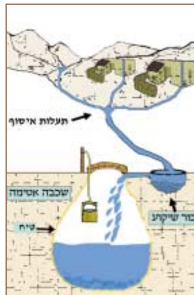
ציור סכמטי של בור מים ומערכת הניקוח שלו. באדיבות נועם דרורי
